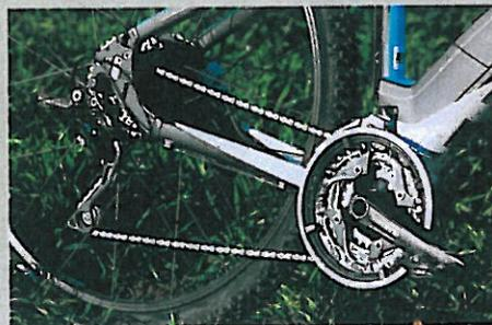
La transmission, confiée à Shimano avec du LX à l'avant et XT à l'arrière, est fiable et sans fioritures. Malgré le moteur, il faudra toujours adapter le braquet au relief.
